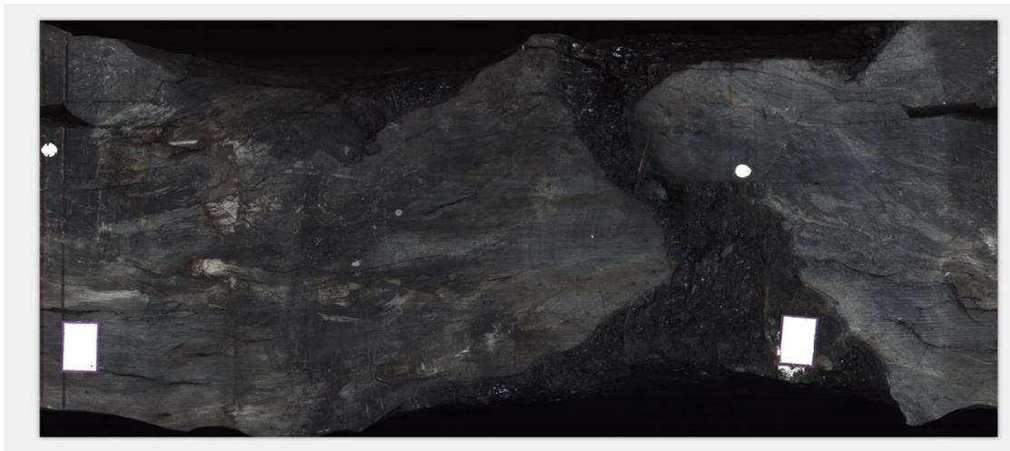
图4 泥岩夹煤层沉积地层岩心扫描图像
