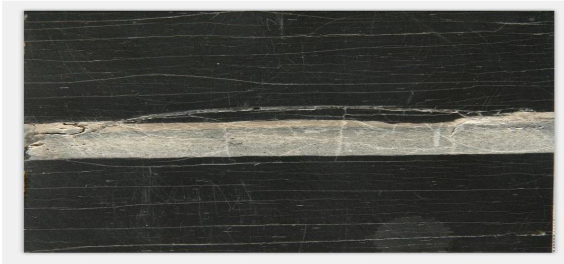
图1 火山灰夹层地层岩心扫描图像
